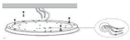
**IT** • Passare i fili attraverso il foro di cablaggio nella base, quindi allineare i fori di montaggio con i tasselli. Fissare la base al soffitto. Assicurati che la base sia installata in modo sicuro.
